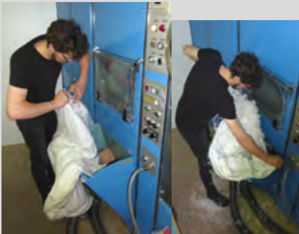
Die Füllung wird entnommen und in die Maschine eingesaugt
