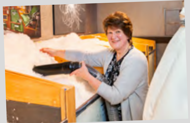
Die gewaschenen Federn und Daunens werden in eine neue Hülle eingefüllt
